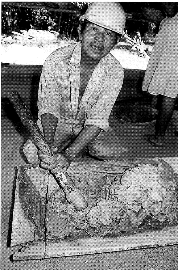
L'argile est débarrassée de ses impuretés avant d'être malaxée pour devenir plus plastique. Village palikur de Persévérance. (photo Rostain, 1989)
